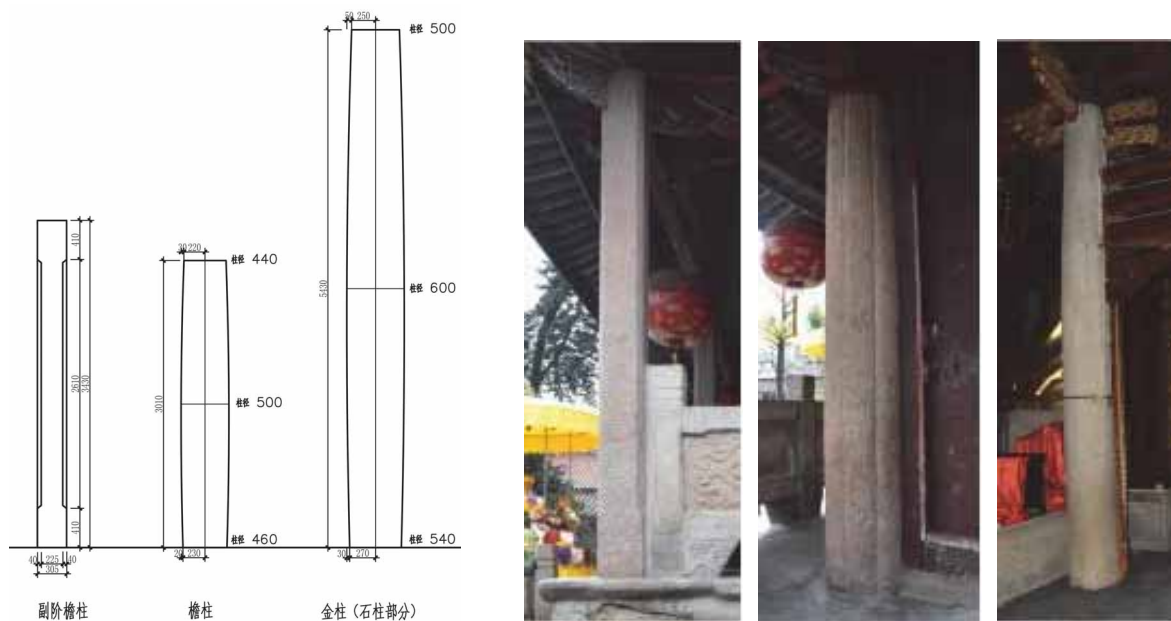
图 4-48 开元寺大殿柱式图
