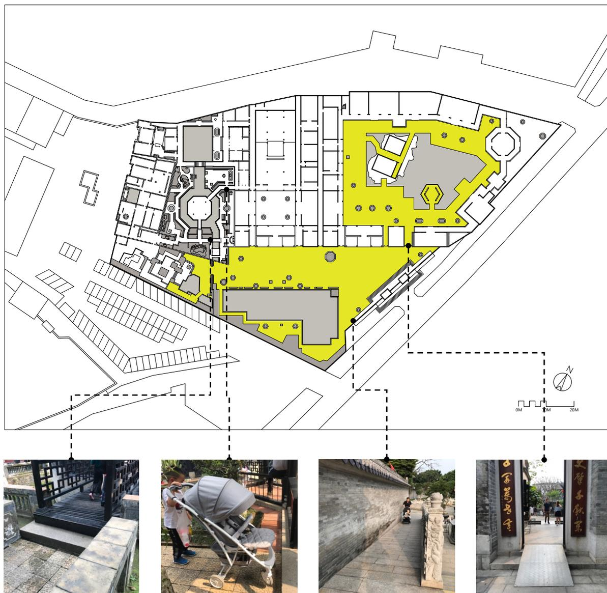
图 4-24 余荫山房无障碍设施示意图（图片来源：作者自绘）
