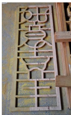
图 5-11 使用拉花机拉出的格心以及细部
