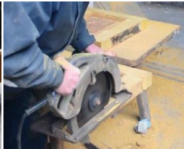
图 5-2 用手提电锯修整横头厚度
