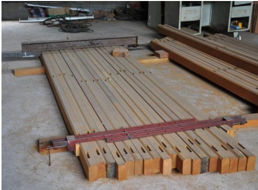
图 3-17 使用工字闸防止边梃变形
